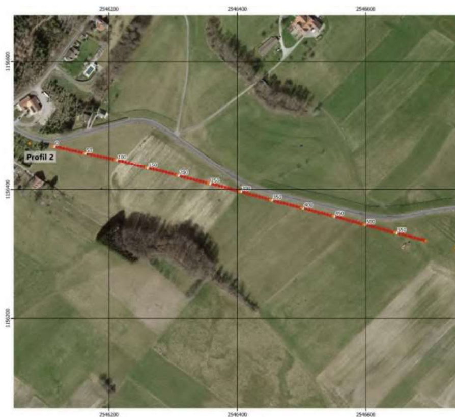
Figure 6 : Savigny. Site de la Goille. Situation des profils géophysiques (ERT et sismique) réalisés par Geo2X le 3 mai 2023 (source : Geo2X, 2023).
